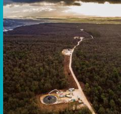
Chaque éolienne nécessite actuellement une surface de défrichement de 3000 m² au maximum. Un chemin d'accès empierré sera créé et une zone adjacente à la piste sera élaguée pour assurer la largeur suffisante du chemin, de 6,50m en ligne droite. La remise en état de
